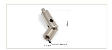
Der Drahtseilhalter / Gripper hat ein Gelenk um Lasten flexibel abzuhängen. Das Gelenk hat ein M5-Gewinde, an dem verschiedene Koppelteile mit M5-Gewinde eingeschraubt werden können.
