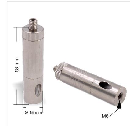
Dieser Drahtseilhalter/Gripper kann durch das Innengewinde direkt an die abzuhängende Last angekoppelt werden. Entweder wird der Drahtseilhalter direkt in ein M6 Bolzen eingeschraubt oder mittels einem M6 Gewindestift an der abzuhängenden Last angekoppelt.
