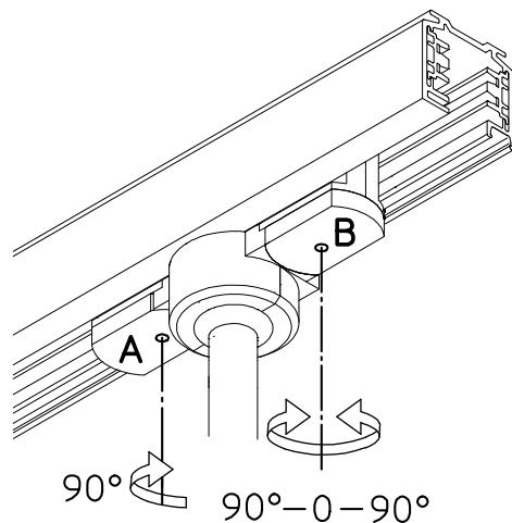
Drehriegel **A** um 90° im Uhrzeigersinn drehen, um den Adapter an die neutrale Phase 0 anzuschließen.
