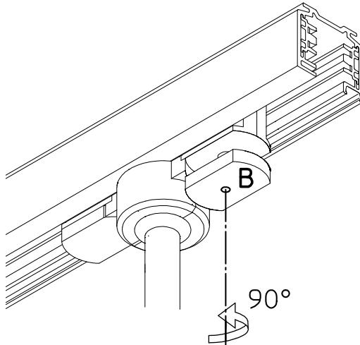
Drehriegel **B** herausziehen und um 90° gegen den Uhrzeigersinn drehen, um den Adapter an Phase 3 anzuschließen.
